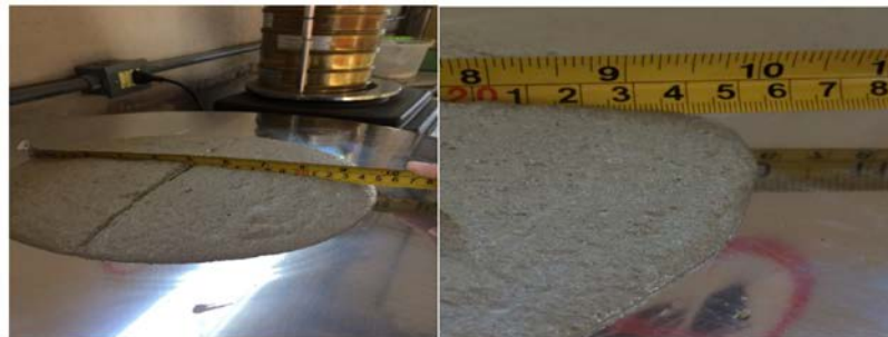
Figura 1: ensaio de consistência das argamassas.
