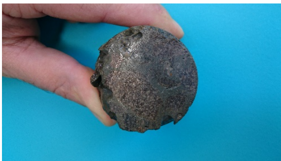
Figura 4 – Amostra do CP com total fechamento dos vazios
