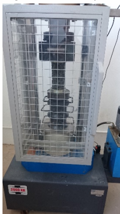
Figura 3 – Rompimento do CP
